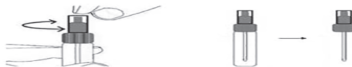
نحوه باز کردن لوله جمع‌آوری نمونه
